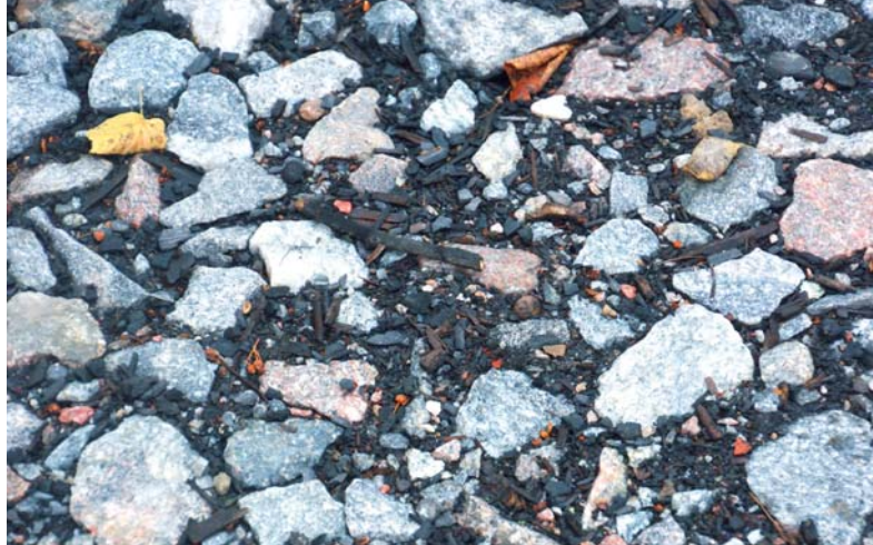
Figur 6. Komprimeret granit-makadam med biokul.
